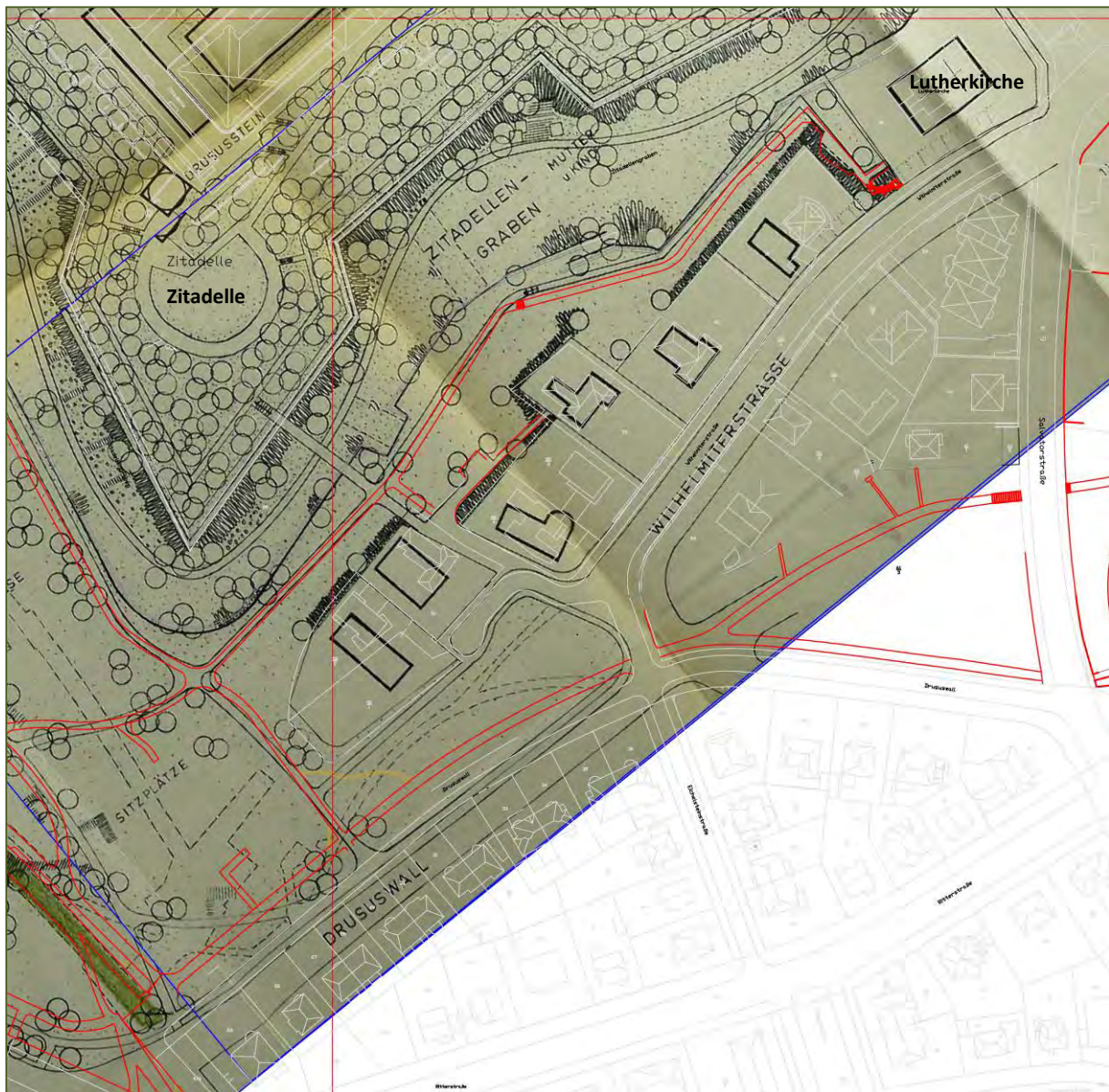
Abb. 62 Planüberlagerung: Entwurf 1962 (Ausschnitt) mit projektierte Wegeführung zur Lutherkirche (grau) – Wegebestand 2017 (rot)
