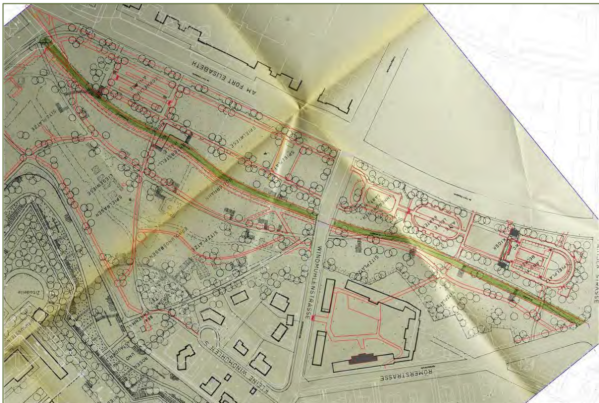
Abb. 61 Planüberlagerung: Entwurf 1962 (Ausschnitt) mit Erweiterungsflächen am Zitadellengraben (grau) – Wegebestand 2017 (rot)
